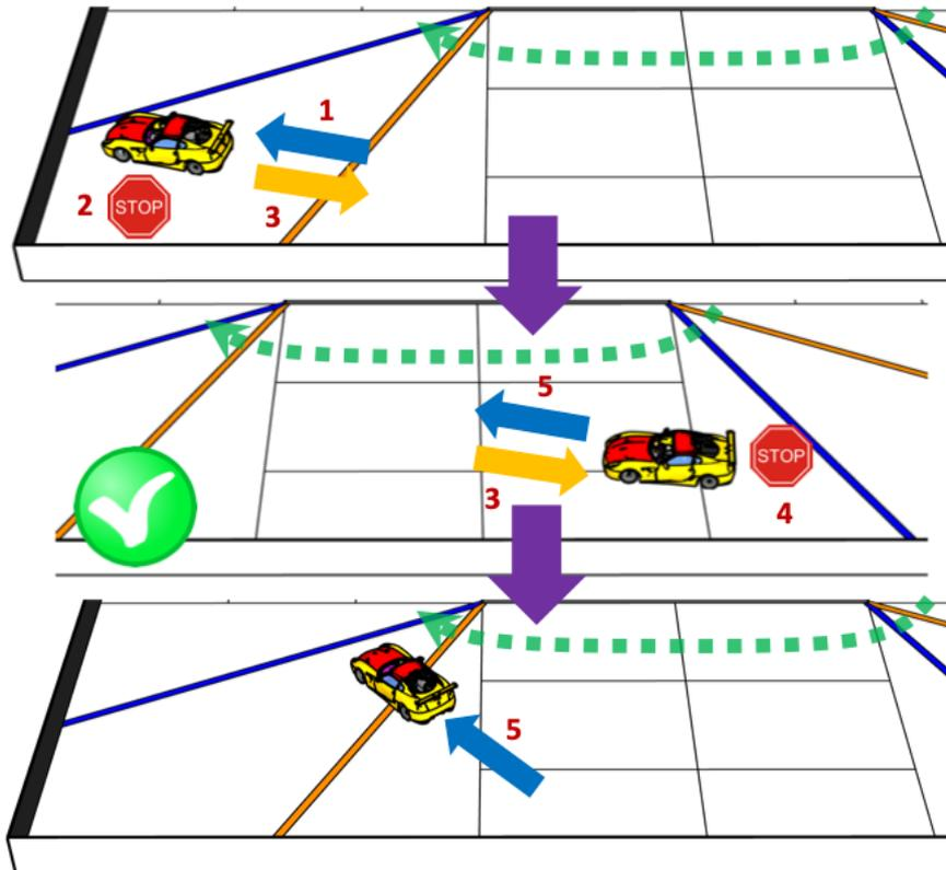
图 25. 车辆开始朝反方向前进，并停在两个区域之间。
